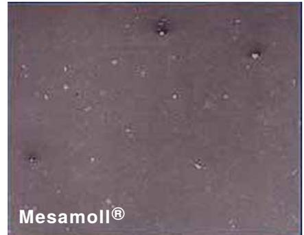
„Im Freibewitterungsversuch von Weich-PVC-Folie zeigt Mesamoll® im Vergleich zu herkömmlichen DEHP-Weichmachern einen wesentlich geringeren Abbau. Das Ergebnis: Während die DEHP-Folie nach 5 Jahren bereits deutliche Schädigungen aufweist, sind die mechanischen Eigenschaften der Folie mit Mesamoll® fast konstant.“ Quelle: [www.lanxess.de](http://www.lanxess.de)
