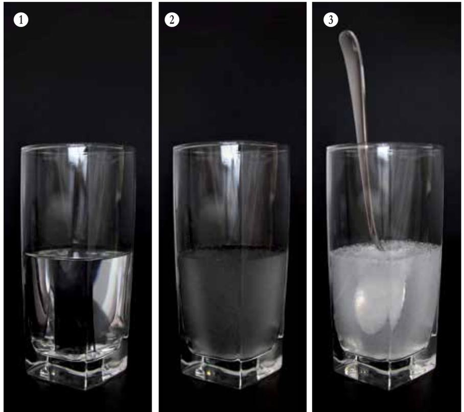
① Wasser ohne Granulat; ② Wasser mit wenig Granulat; ③ Wasser mit viel Granulat, sodass der Löffel in dem Glas stehen kann.
